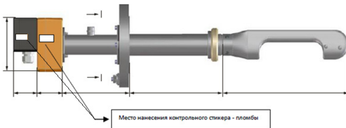
Рисунок 2 – Схема пломбирования. Блок электроники
