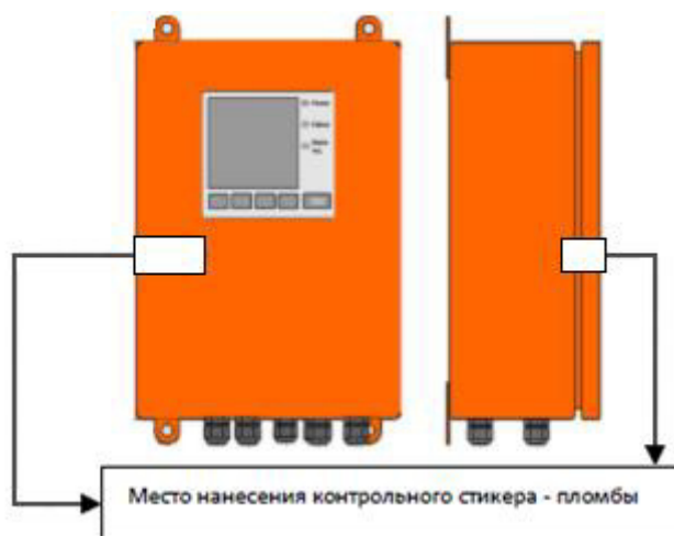
Рисунок 2 – Схема пломбирования. Блок электроники
