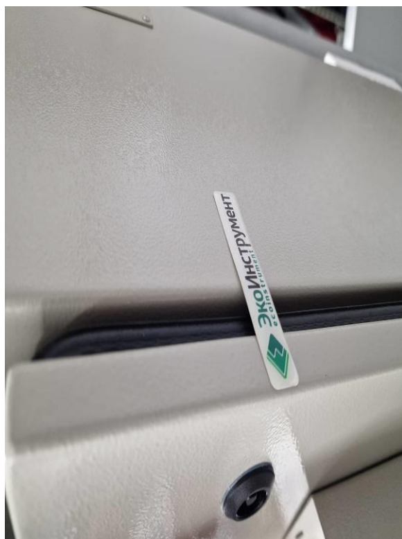
Рисунок 11 – Пломбирование анализаторов на примере контроллера и аналитического модуля ЭКОМАК
