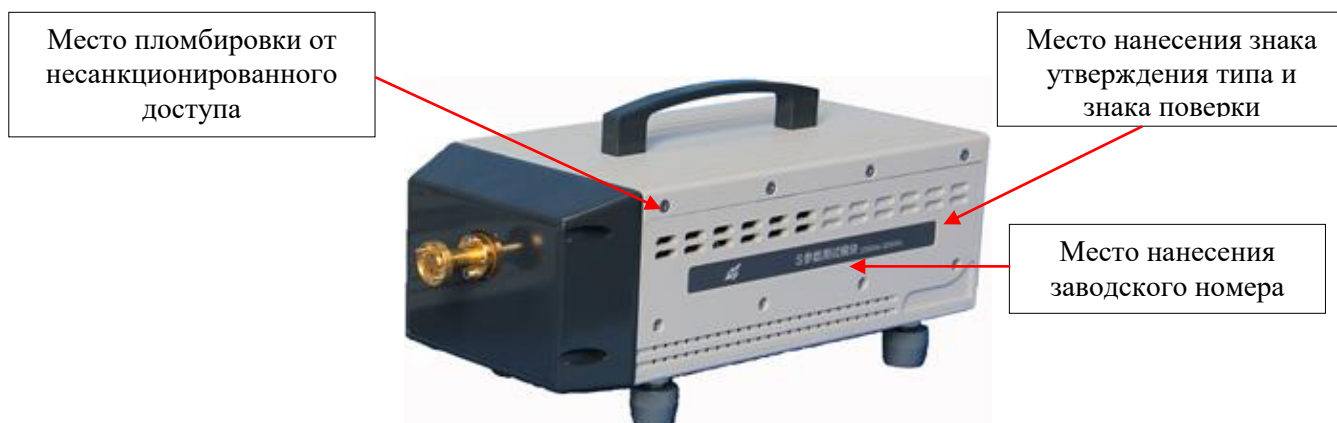
Рисунок 2 – Общий вид МРЧД в первом исполнении
