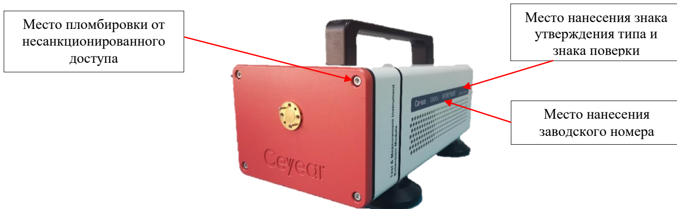
Рисунок 3 – Общий вид МРЧД во втором исполнении
