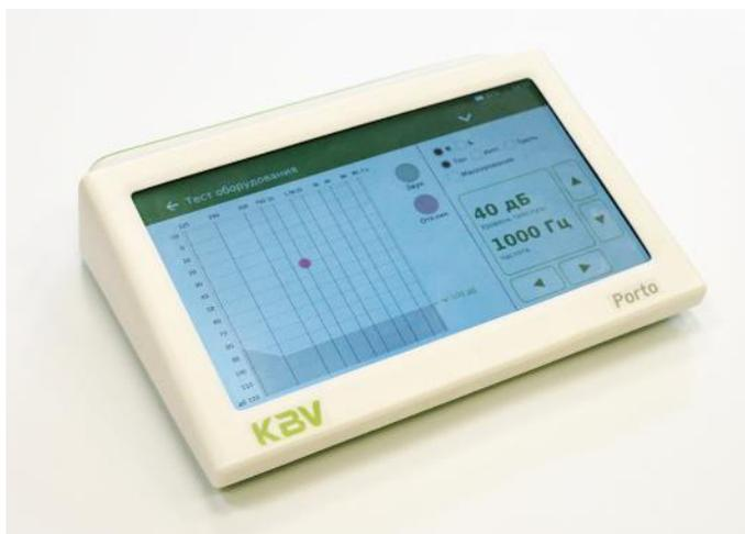
Рисунок 1 – Общий вид аудиометров
