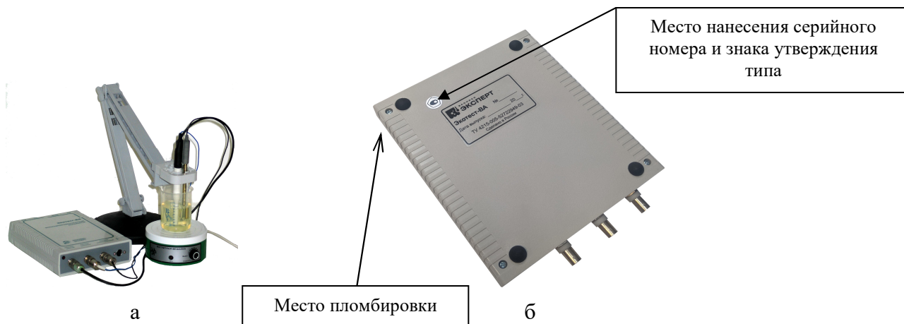
Рисунок 1-Внешний вид ИП анализатора ЭКОТЕСТ-ВА с электрохимической ячейкой (а), место пломбировки ИП анализатора от несанкционированного доступа, место нанесения серийного номера и знака утверждения типа (б)
