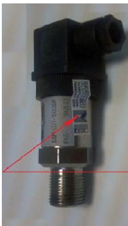
Рисунок 2 – Место пломбирования датчиков ДДМ-03Т-ДИ
