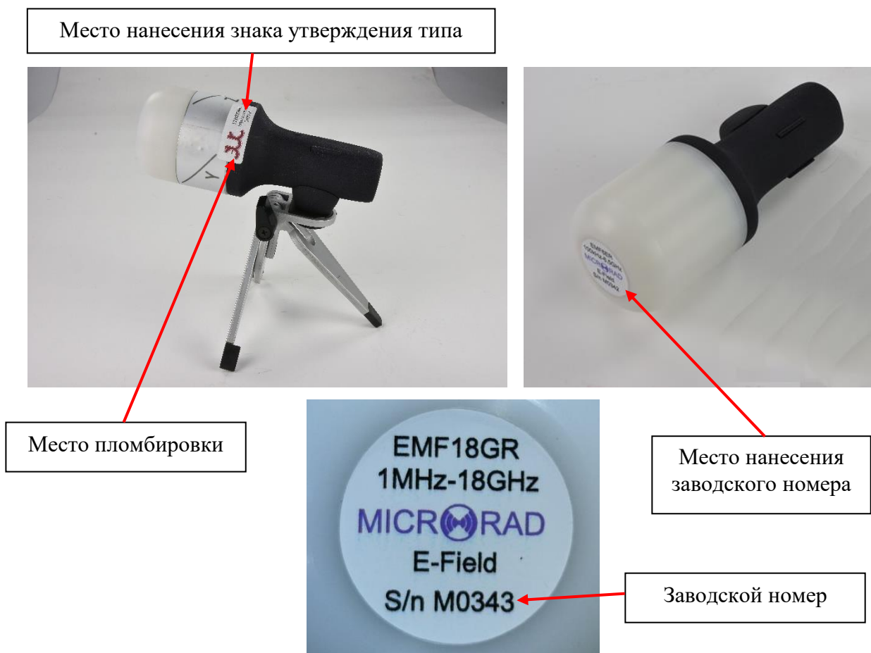
Рисунок 2 – Общий вид измерителей EMF с указанием мест пломбировки, нанесения знака утверждения типа, нанесения заводского номера
