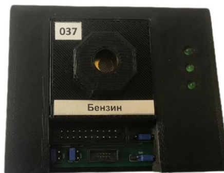
в) Газоанализаторы в сборе: модуль измерительного преобразователя (МИП) и модуль преобразования интерфейсов (МПИ).
